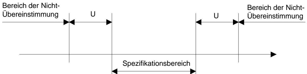
Bild 3-5: Bereich der Nicht-Übereinstimmung bei zweiseitiger Spezifikation
