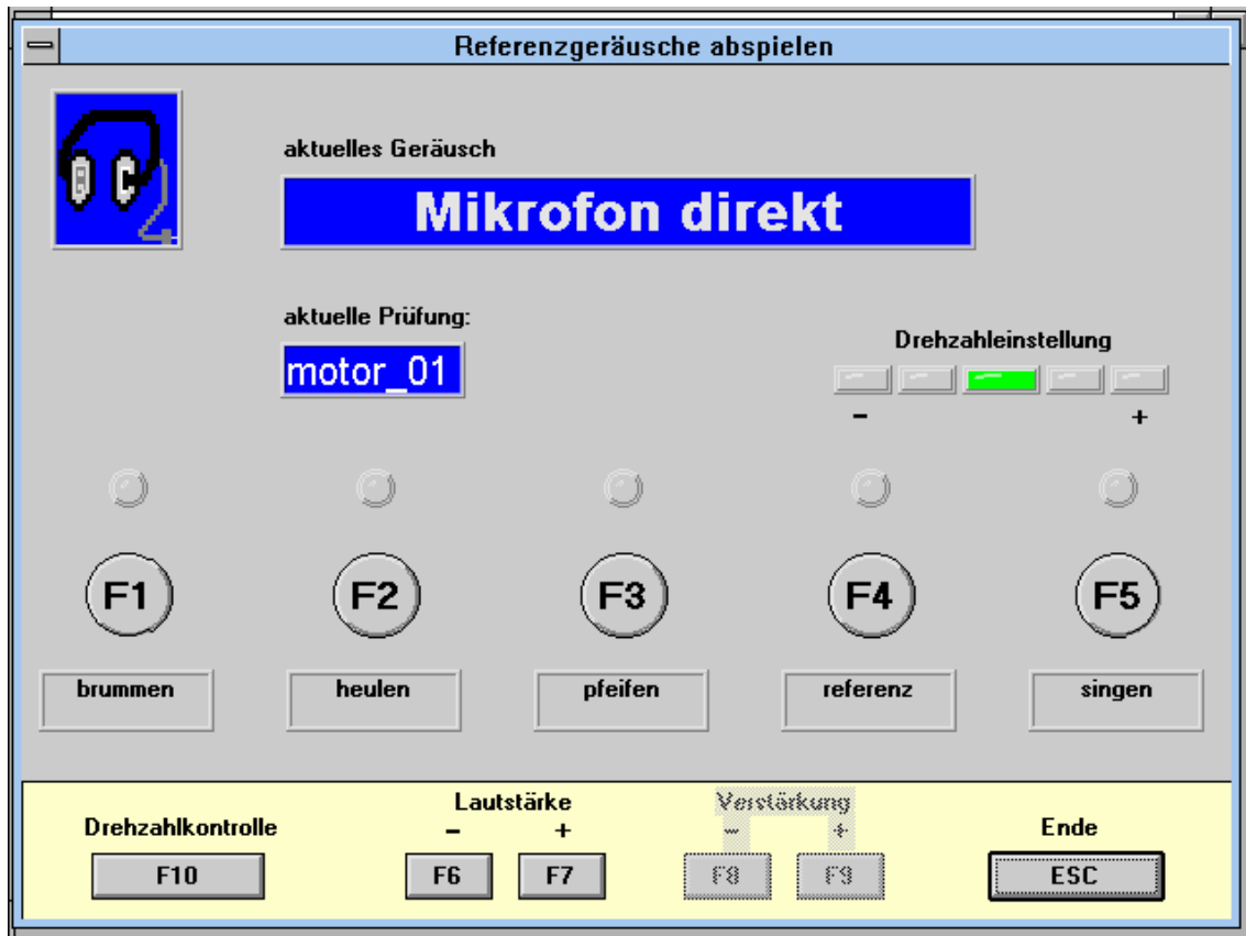
Bild 3: Anwendungsbeispiel einer unterstützten subjektiven akustischen Prüfung von Elektromotoren
