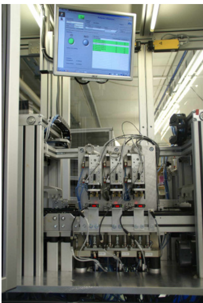
Abbildung 3: Vollautomat zur Prüfung von Schrittmotoren
