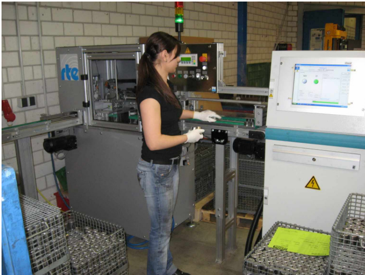
Abbildung 4: halbautomatische Prüfsystem für Rotoren aus Eisenpulver
