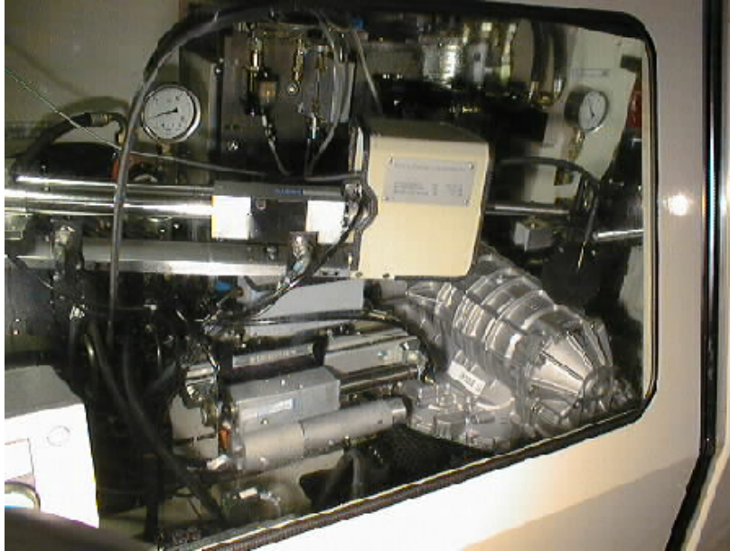
Bild 4: Luftschallbasierte Geräuschprüfung mit Fehlerdiagnose an Automatikgetrieben
