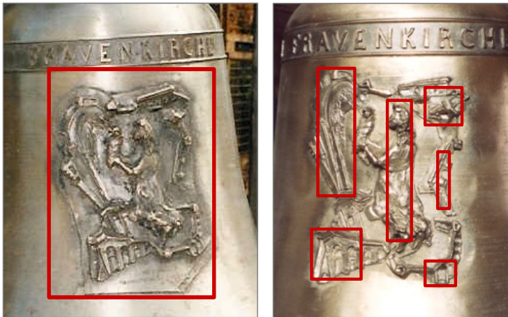
Abb. 11: Wirksame Fläche und Dicke im Vergleich: Glocke Hanna des ersten (links) und des zweiten Gusses (rechts)
